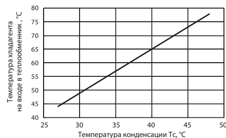
Рис. 2. Температура хладагента на входе в теплообменник
